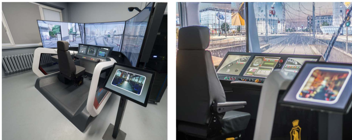
Figura 5-29 Exemplo de Simulador de Operação de Trens e as imagens visualizadas
