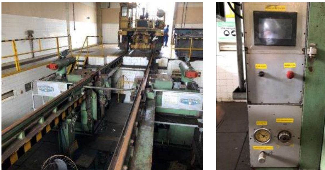
Figura 5-51 Torno subterrâneo de rodas
