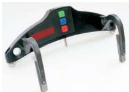
Figura 5-39 Medidor de Diâmetro de Rodas
