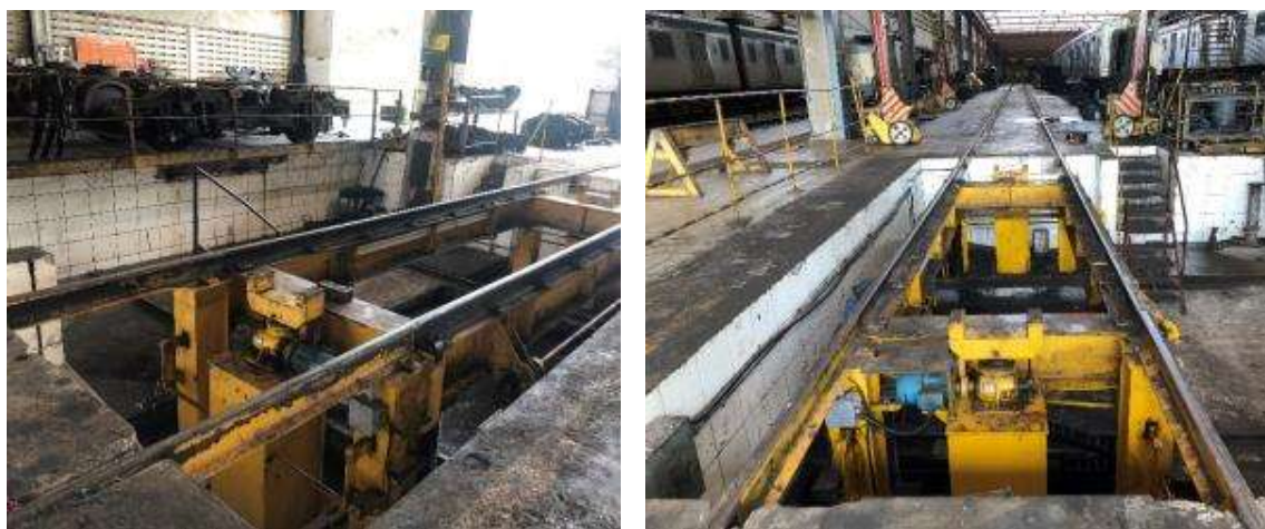
Figura 5-34 Mesa falsa para troca de truques Ref. HS-DT-TRQ-1.6
