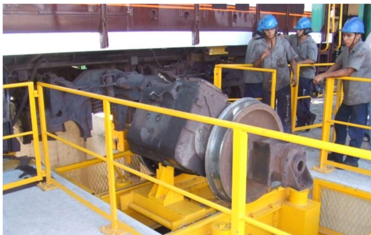
Figura 5-44 Mesa falsa para troca de truques tipo DROP TABLE
